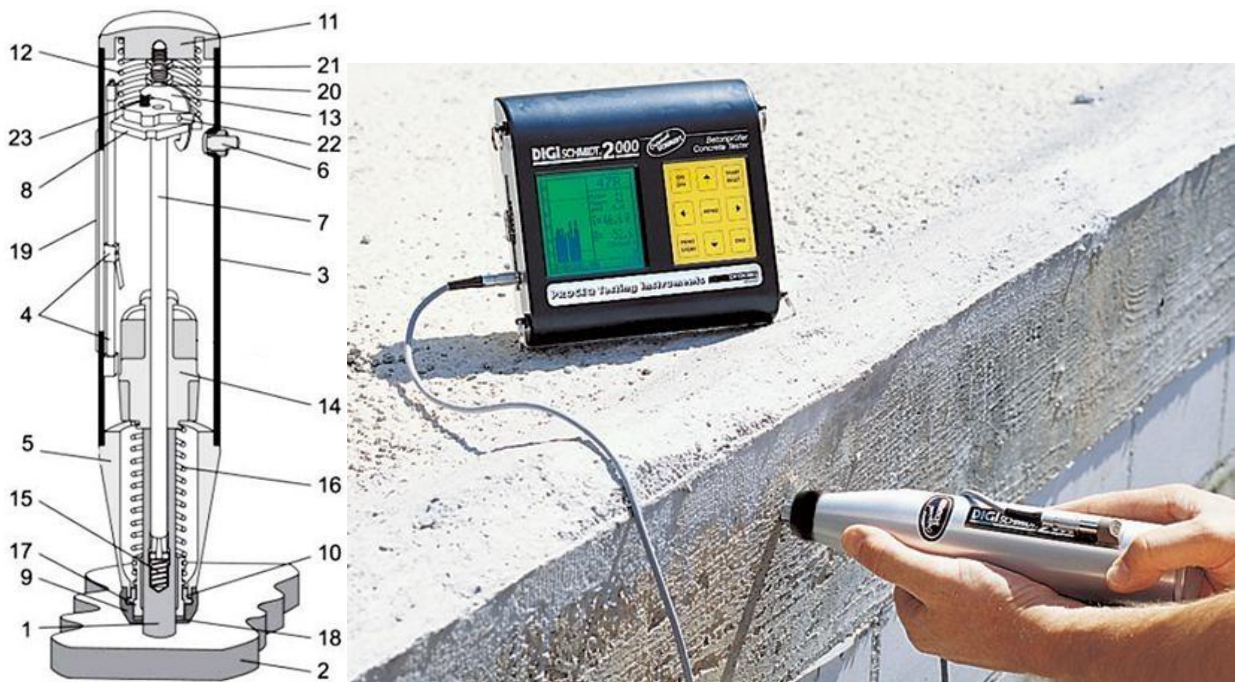
Рисунок 2.2 – Молоток Шмідта: а – схематична будова; б – приклад використання; 1 – ударний плунжер; 2 – бетонна поверхня; 3 – корпусна частина; 4 – повзунок, оснащений напрямними стрижнями; 5 – конус корпусних частини; 6 – кнопка-фіксатор; 7 – шток бойка; 8 – шайба для установ-лення бойка; 9 – ковпачок; 10 – кільце для рознімання; 11 – задня кришка інструмента; 12 – стискальна пружина; 13 – запобіжна частина конструкції; 14 – бойок; 15 – пружина для фіксації; 16 – ударна пружина; 17 – втулка; 18 – повстяне кільце; 19 – дисплейне вікно; 20 – гвинт зчеплення; 21 – контрольна гайка; 22 – штифт; 23 – запобіжна пружина
