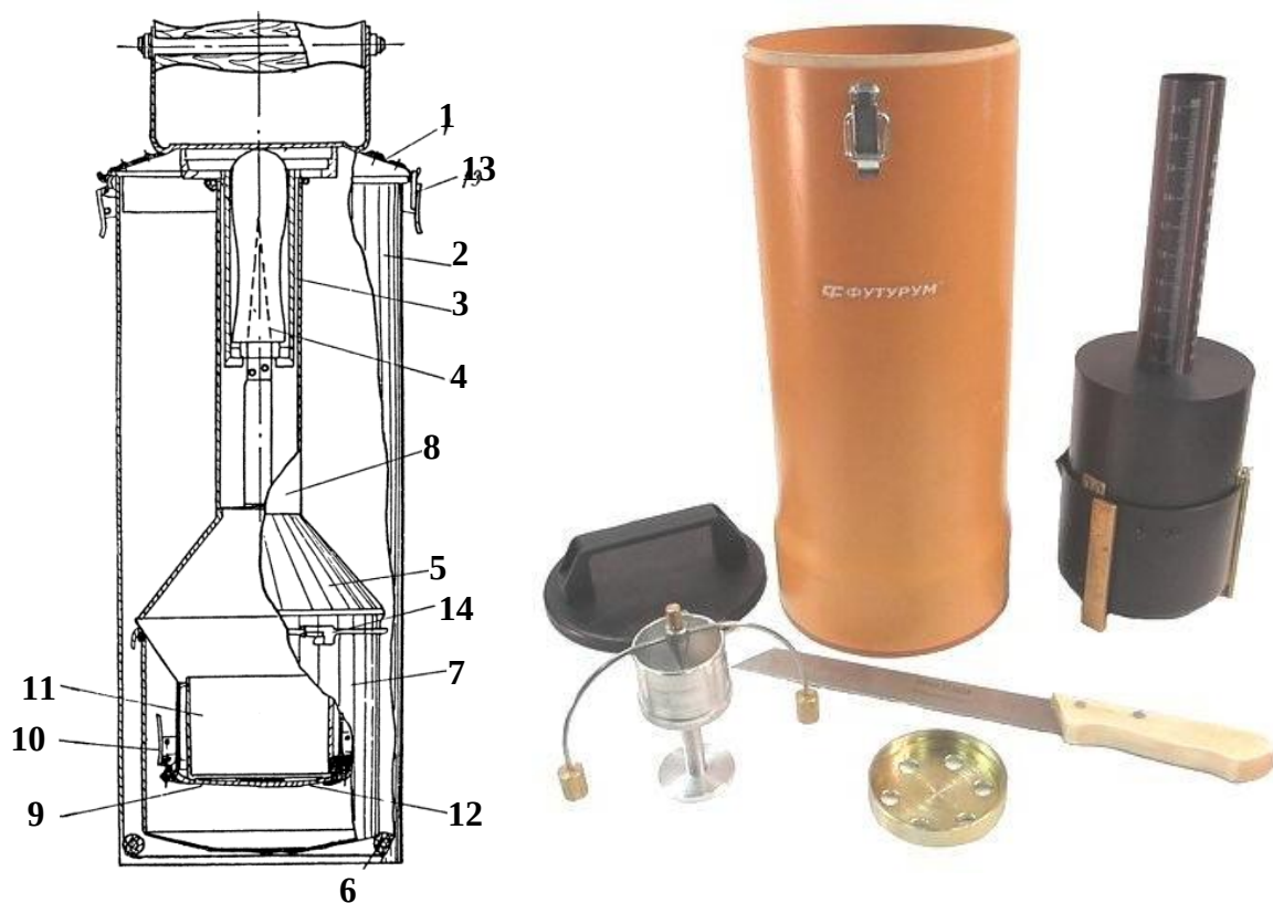
Рисунок 2.15 – Густиномір-вологомір Ковальова: 1 – кришка футляра; 2 – відро-футляр; 3 – сталева насадка; 4 – ніж; 5 – поплавок; 6 – гумове кільце; 7 – судина; 8 – трубка поплавка; 9 – кришка поплавка; 10 – замок поплавка; 11 – різальний циліндр; 12 – тарувальний вантаж; 13 – замок футляра; 14 – гачки
